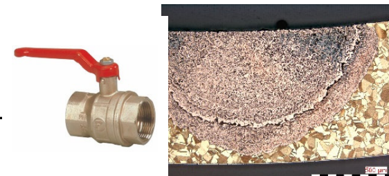
Bsp. Entzinkung Messing
