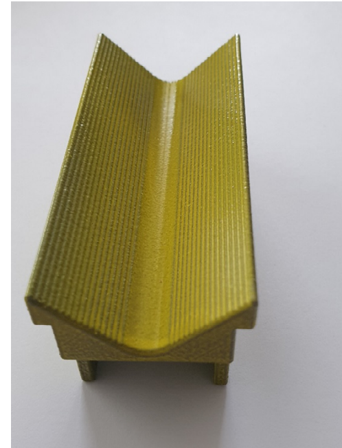
Rechts: kugelgestrahlt mit Chromophorer AAA COAT- Beschichtung
