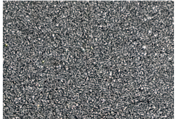
Abb. 7b: Detailsicht einer SiC- pigmentierten AAA-Coat Schicht auf verzinktem Untergrund
