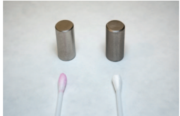
Abb. 6b: Vernickelte Möbelknöpfe. Linke Seite nicht beschichtet. Rechte Seite mit AAA-Coat (matt) veredelt. Der Nickel-Test zeigt die Ablösung von Nickel-Ionen am nicht beschichteten Möbelknopf (rot gefärbtes Wattestäbchen)
