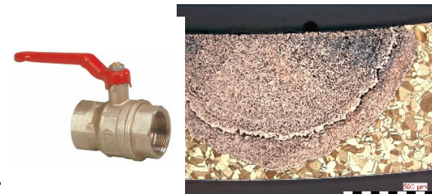
Bsp. Entzinkung Messing
